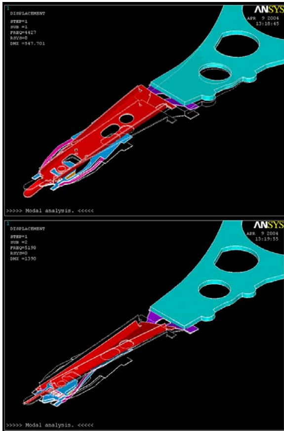
ภาพที่ 7 : รูปร่างของชุดอ่านเขียนจากการวิเคราะห์ด้วยวิธีการจำลองโดยไฟไนท์เอลิเมนต์
